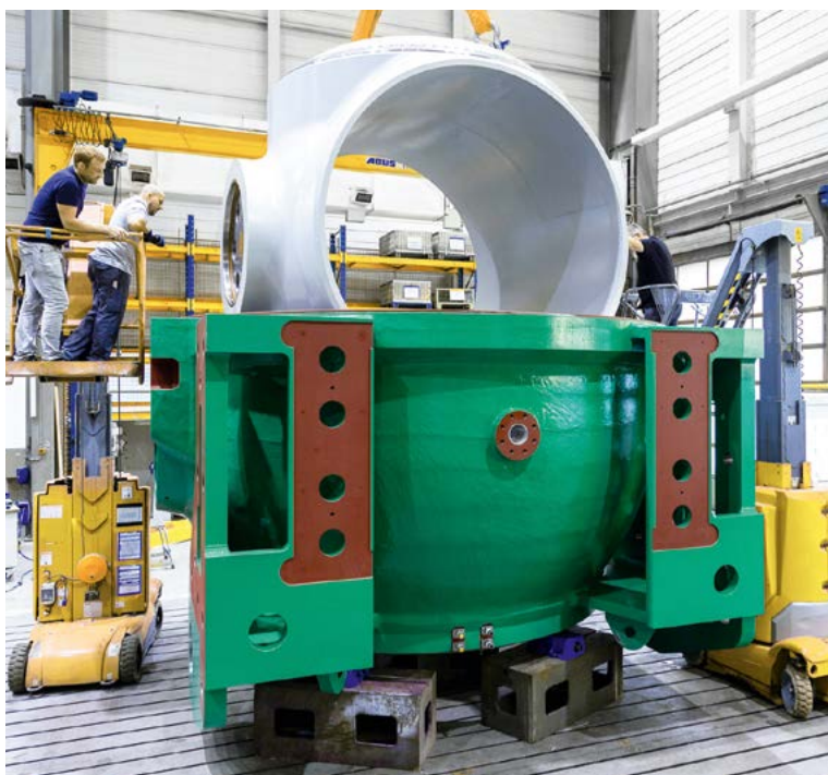
Assemblage du rotor de la vanne dans le corps de la MIV
