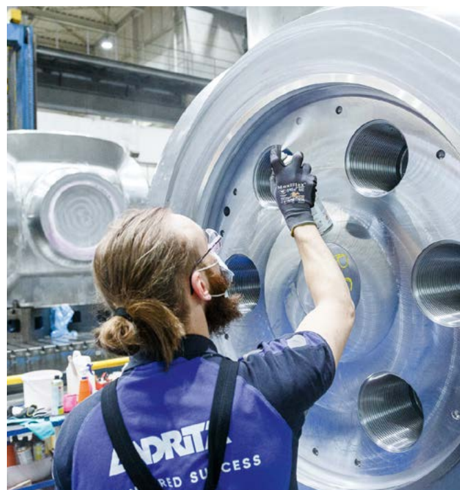
Inspection des fissures sur les surfaces d'étanchéité du rotor de la vanne
