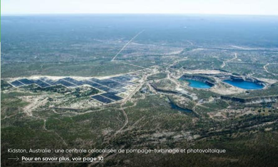
Kidston, Australie : une centrale colocalisée de pompage-turbinage et photovoltaïque
