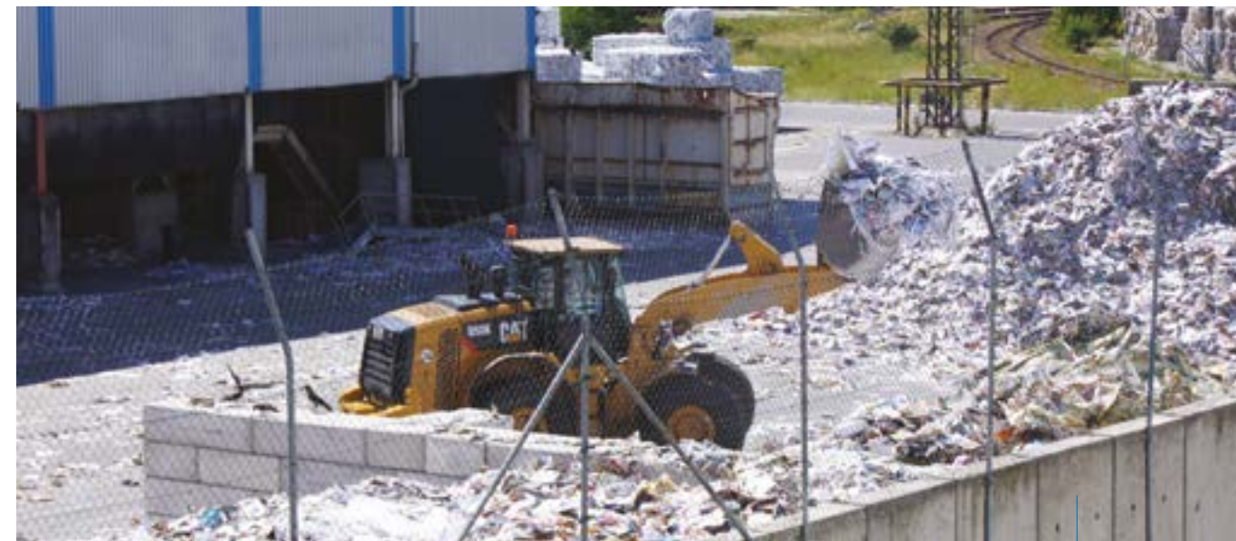
Рыхлая масса сырья, содержащего печатные краски (иллюстрированные журналы и газеты, глянцевые обложки журналов) поступают в DIP1
