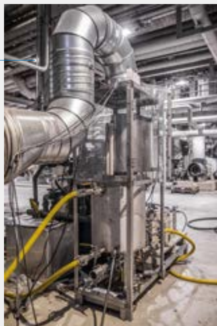
Рис. 2. ANDRITZ начала проверку альтернативных концепций восстановления лигнина на опытной установке в 2010 г. Показана мобильная опытная установка, которую легко доставить на производство
