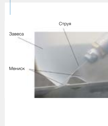
Рис. 3. Принцип действия новой системы направления кромок от компании ANDRITZ
