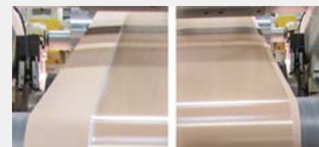
Рис. 4. Сравнение сразу после нанесения покрытия: с традиционной механической системой (слева) и с системой направления кромок от компании ANDRITZ (справа)
