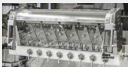
Рис. 1. Прототип новой форсунки с посекционной объемной коррекцией профиля в поперечном направлении
